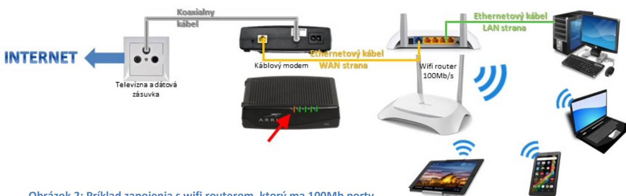
Obrázok 2: Príklad zapojenia s wifi routerom, ktorý ma 100Mb porty
